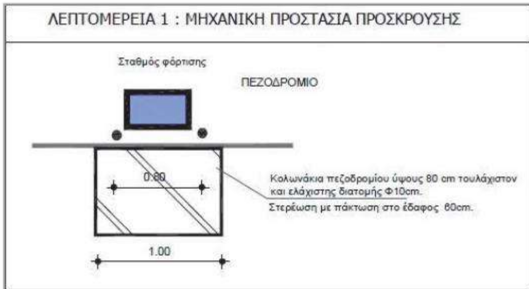
Εικόνα 27: Λεπτομέρεια μηχανικής προστασίας
